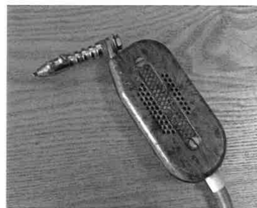
ნახ. 3.10 ელექტრონაპერწკლური ლეგირების ხელსაწყოს ელექტროდის დამჭერი.
