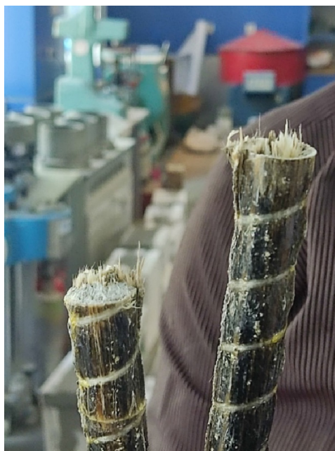
სურ. 21. ჭრაზე გამოცდილი ბაზალტკომპოზიტური არმატურები
