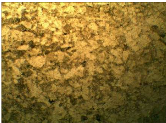
სურ. 16. ა. ppl და ბ. xpl, კვარციანი ქვიშაქვის მიკროფოტოები. x40.
