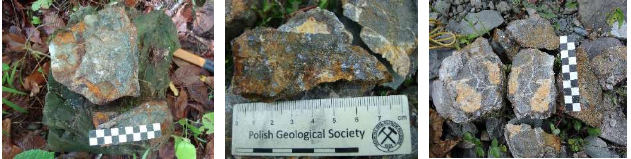
სურ. 7. ა - შეცვლილი ქანი; ბ - გალენიტის, სფალერიტის და პიროტინის ჩანართები ნაპრლებში; გ - ჰიდროთერმული ბრექცია.
