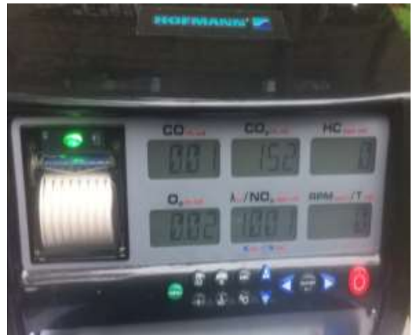
ნახ. 3.13. აირანალიზატორ Multitest 211 მიერ დაფიქსირებული მონაცემები ძრავის დატვირთვის რეჟიმზე მუშაობისას ( n=3000 \text{ წთ}^{-1} ) ბენზინი და ბენზინი + წყალბადი
