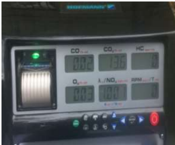
ნახ. 3.13. აირანალიზატორ Multitest 211 მიერ დაფიქსირებული მონაცემები ძრავის დატვირთვის რეჟიმზე მუშაობისას ( n=3000 \text{ წთ}^{-1} ) ბენზინი და ბენზინი + წყალბადი
