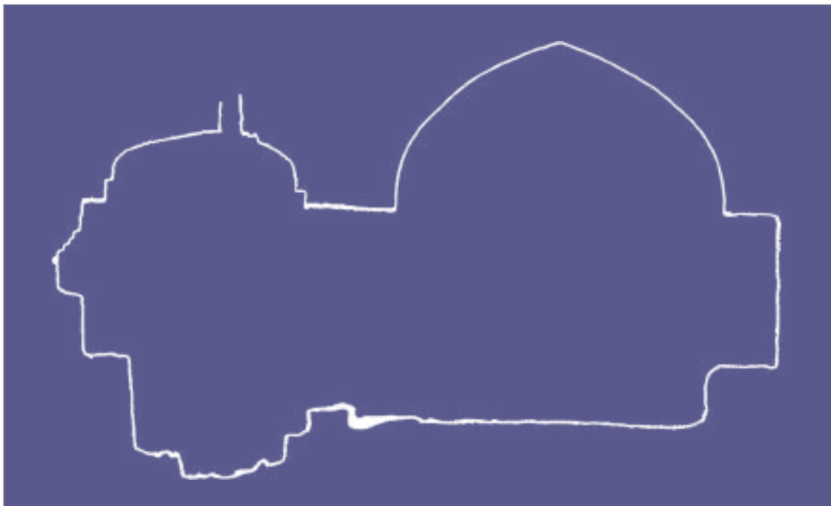
ნახ. 4. გ. აბესაძის ქ. №21 XVII ს. ორსადგომიანი სარდაფის ფოტოგრამეტრიული ჭრილი აღმოსავლეთ-დასავლეთის ღერძზე, 2024
