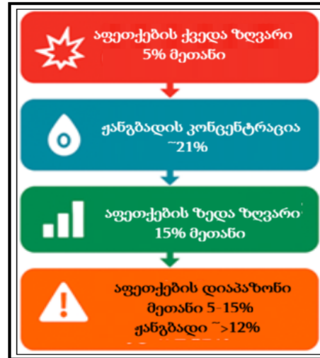
ნახ. 3.5. მეთანის აფეთქებადობის ზღვრები ჰაერში არსებულ ჟანგბადთან
