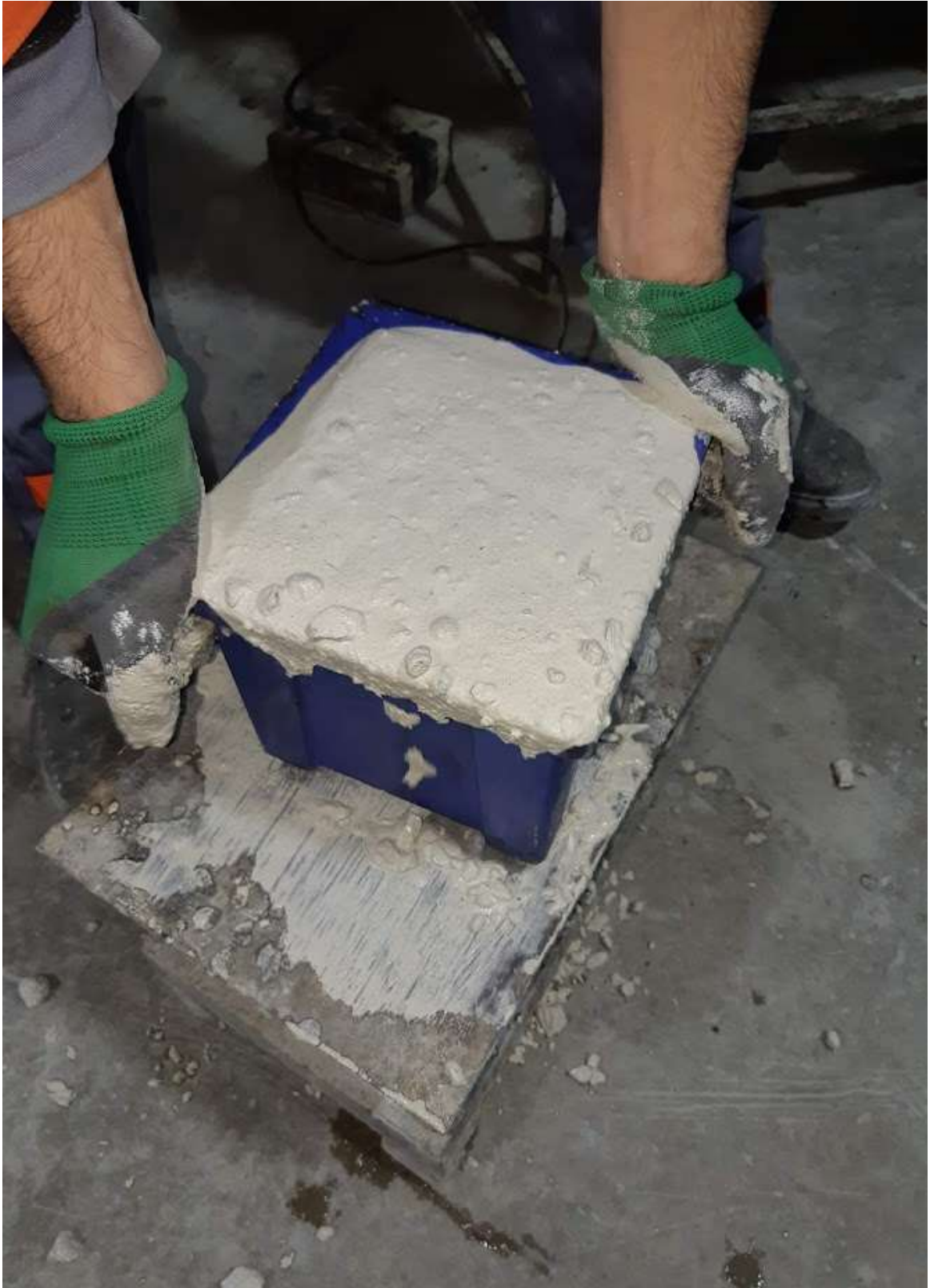
სურათი №28 - თეთრი არქიტექტურული ბეტონის ნარევიდან ნიმუშის აღება
