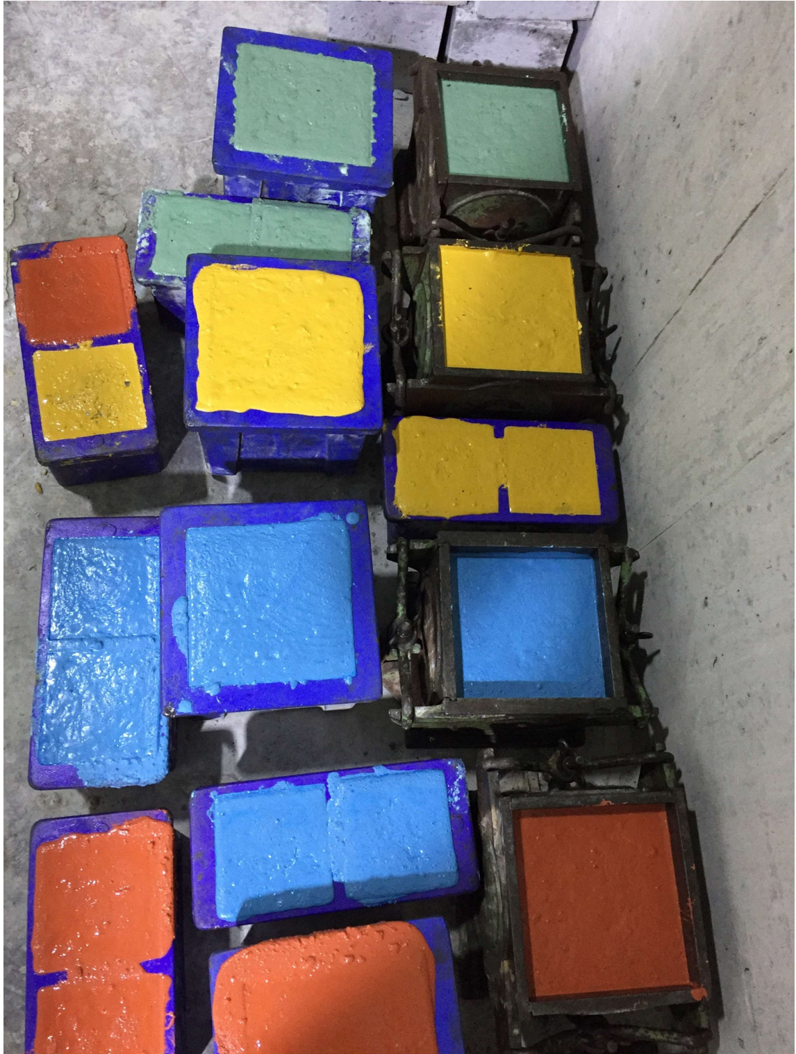
სურათი №22 - წითელი, ყვითელი, მწვანე და ლურჯი ფერად-არქიტექტურული ბეტონების ნიმუშები.
