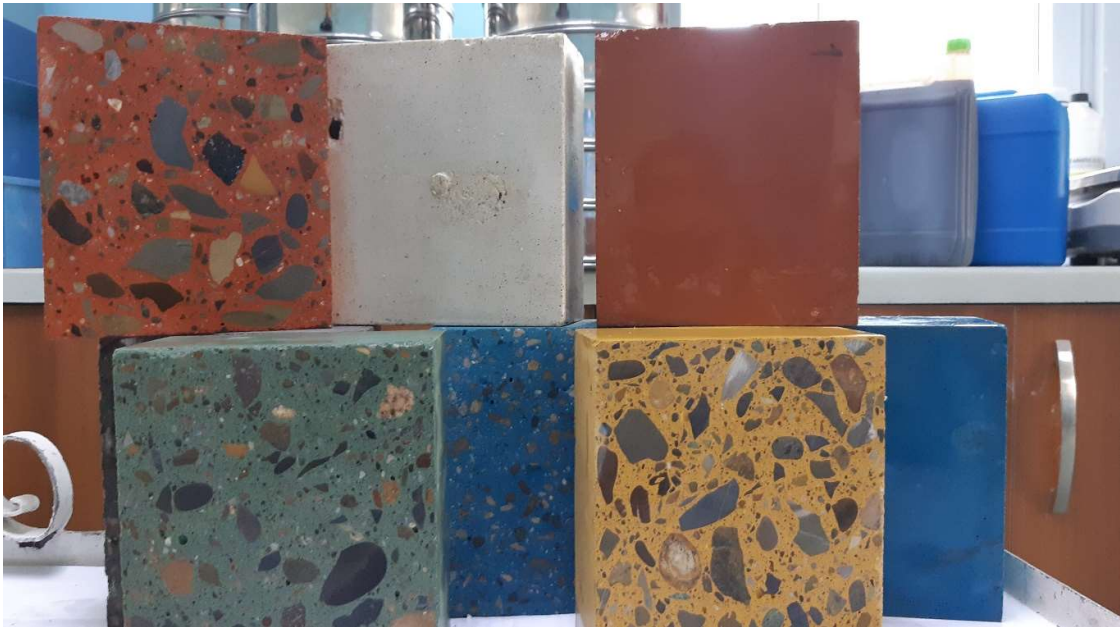
სურათი №23 - წითელი, ყვითელი, მწვანე და ლურჯი ფერად-არქიტექტურული ბეტონების ნიმუშები, დამუშავების შემდეგ
