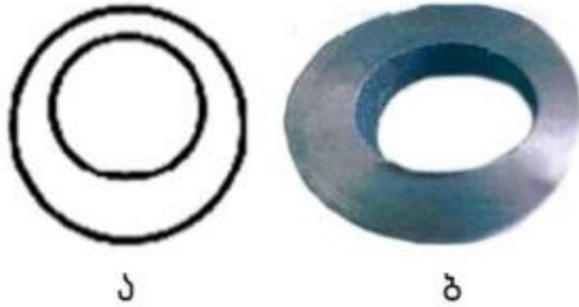
სურ. 11. ნაირკედლიანობა: ა - სქემა; ბ - დეფექტური სხმული
