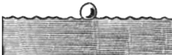
სურ.104. საფანტით ციკქედვის შემდეგ დეტალის ზედაპირის გადიდების სქემა
