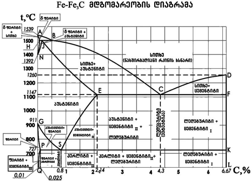
სურ. 69. რკინა - ცემენტიტის დიაგრამა
