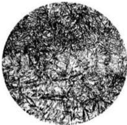
სურ. 83. ბეინიტის მიკროსტრუქტურა
