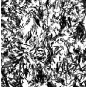
სურ. 86. მარტენსიტის მიკროსტრუქტურა, X500
