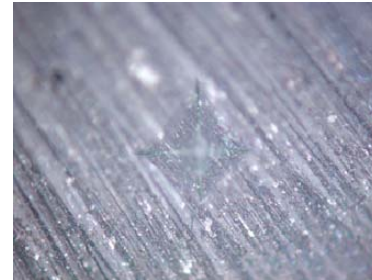
სურ. 4.19. ა); ბ) N20- კომპოზიტის HV მონაცემები ა) ნიმუშზე ინდენტორის დატვირთვისა და გავლილი გზის დამოკიდებულება დროში, ბ) ინდენტორის ანაბეჭდის სურათი
